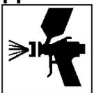
Pistolet conventionnel : Buse de 1,3 à 1,6 mm
