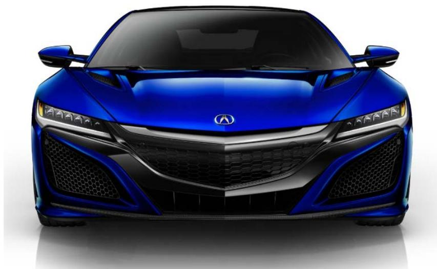
En algunos acabados automotrices originales de fábrica de la actualidad se utiliza una capa transparente entintada para producir un efecto impecable de color azul caramelo. El proceso de reparación de estos colores requiere una capa de revestimiento transparente que se aplica sobre los sistemas de capa base AQUABASE® Plus, DELTRON® DBC, ENVIROBASE® de Alto Rendimiento, GLOBAL REFINISH SYSTEM® BC y NEXA AUTOCOLOR® 2K®.
