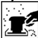
Metal descubierto: Lijar a máquina con grano 120-180
