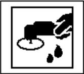
Humedecer la zona a lijar con lijadora Excéntrica (3 mm) y con 3M™ Trizact™ Finesse-It™ disco fino P3000 con un gel de preparación ej. Gel mate o 3 M™ Prep & Blend
