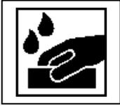
Si fuese necesario, lijar cualquier impureza en el difuminado o eliminar cualquier textura con el disco 3M™ Trizact P3000. No utilice ningún otro abrasivo.
