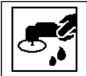
Eliminar cualquier ralladura por lijado con un disco (mojado) de 75mm 3M™ Trizact™ Finesse-It™ P3000 y una lijadora excéntrica (3mm).
