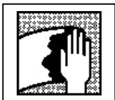
Limpiar el acabado original detenidamente primero con agua para eliminar la suciedad soluble con agua. Limpiar la superficie con Desengrasante D837 (DX330) o Desengrasante Alto Poder D845 (DX310). Si se utiliza Envirobase, limpiar con Desengrasante Especial Bajo VOC D8401
