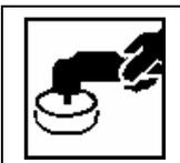
Pulir el área reparada con SPP1001 de Specialty Performance Products de PPG y la almohadilla de espuma naranja de SPP (SPN1902) en una máquina de abrillantado a 1.500 rpm.
