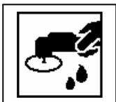
Lijado húmedo del área de difuminado con lijadora excéntrica (órbita de lijado 3 mm) y disco de lijado Trizact™ P3000 (Finesse-it™) de 3M™, juntamente con un gel de preparación (Matt Gel o Prep&Blend de 3M™).
