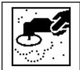
Lijar la superficie con una lijadora excéntrica (órbita de lijado 3 – 5 mm) y con lija Hook-it™ 260L de 3M™ de grano P800–P1200; lijar el perímetro otra vez con almohadilla suave (Soft Pad) ultra fina de 3M™
