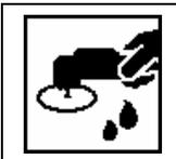
Eliminar cualquier raya de lijado con un disco fino de lijado Trizact™ P3000 (húmedo) de 3M™ de 75-mm y una lijadora excéntrica (órbita de lijado 3 mm)
