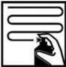
Aplicar 1 demão leve + 1 demão média para obter uma espessura de película mínima de, aproximadamente 25-30 micrómetros.
