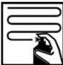
Aplicar 1-2 demãos para uma película com uma espessura de 10-20 micrómetros.
