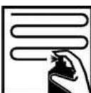
Aplicar 1 demão leve/média seguida de uma demão completa para obter uma espessura de película seca de 50 micrómetros.
